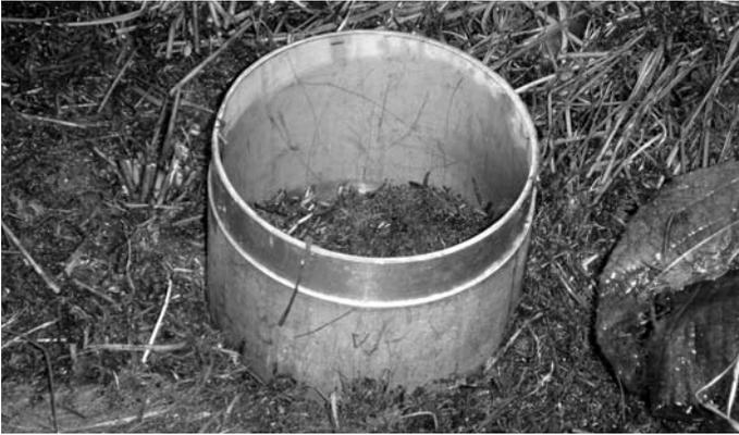
Abb. 3: Das einfache Experiment mit je einem wassergefüllten Zylinder in der Fahrspur und im ungestörten Boden daneben zeigt anschaulich, dass schon ein einmaliges Befahren des Waldbodens zu einem stark reduzierten Sickerungsvermögen des Bodens führt.
