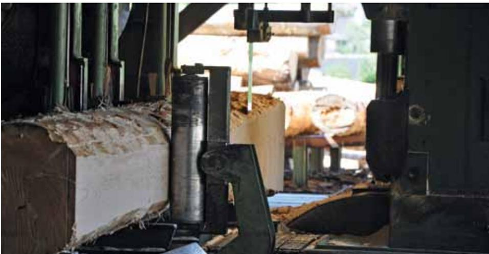
Starkholz auf einer Blockbandsäge
