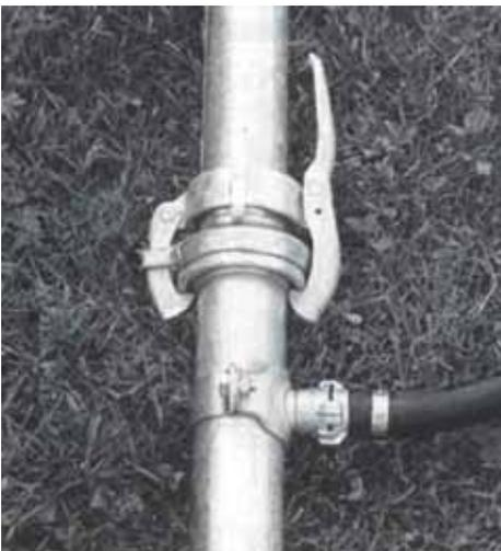
Abbildung 2: Transportleitung aus Schnellkupplungsrohren, mit Abzweigung einer Schlauchleitung
