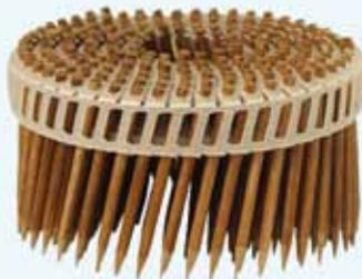
Nägels für das kleinere Nagelpistolenmodell mit Durchmesser von 3,7 mm, Längen von 50, 55 und 65 mm aus verdichtetem Buchenholz
