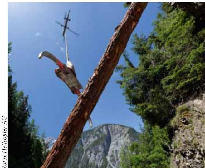
Grapple – die hydraulische Holzzange mit einer Klemmkraft von 2,3 Tonnen
